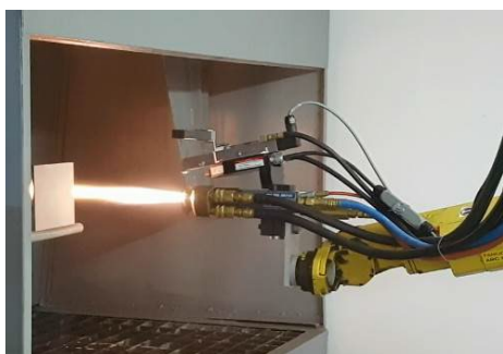
(e) Laborator de ingineria suprafețelor și pulverizare termică (HVOF)
