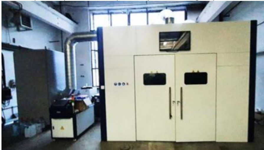
a) Incintă LASER și echipamentele conexe pentru funcționare
