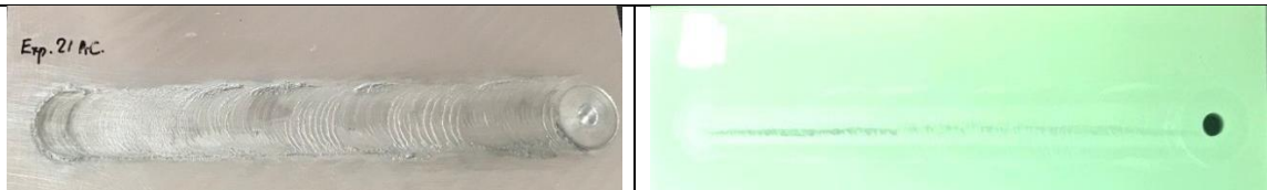
EN AC 5083 (6mm), procesare SFSP într-o trecere
