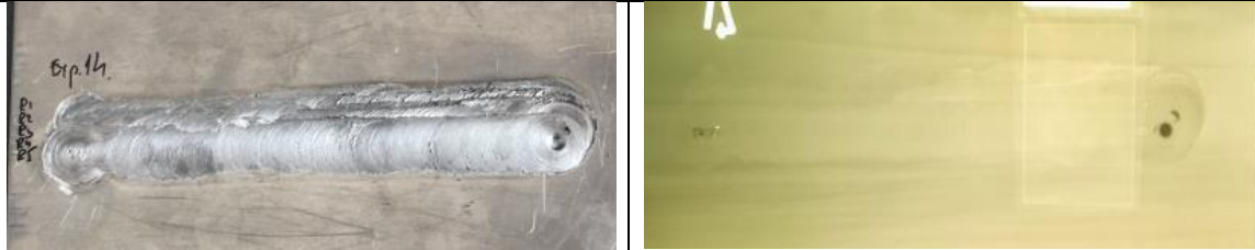
EN AW 6082 (5mm), procesare SFSP în treceri multiple
