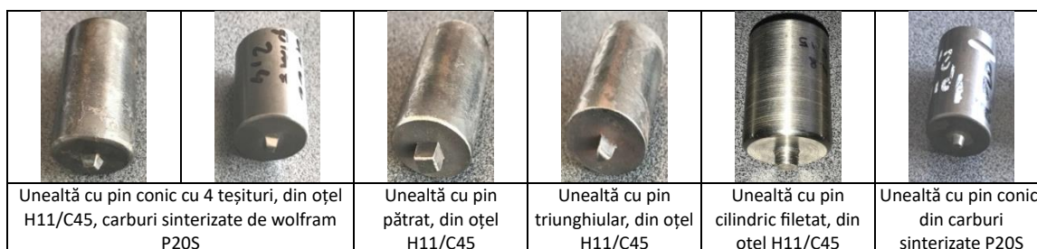
Fig. 1 Unelte de procesare utilizate la cercetările experimentale de procesare SFSP/FSP
