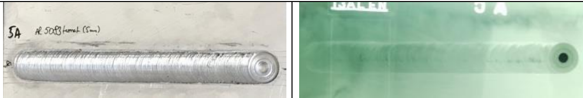
EN AC 5083 (5mm), procesare SFSP în treceri multiple
