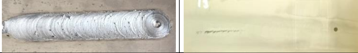
EN AW 5754 (3 mm), procesare SFSP în treceri multiple
