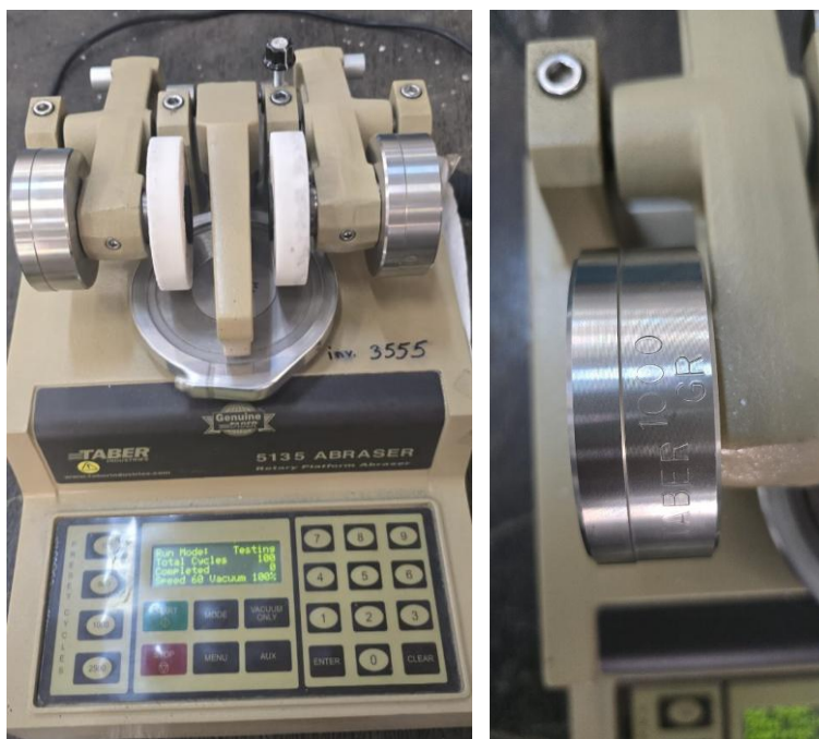
Figura 15. a) Aparatul de uzură abrazivă cu platformă rotativă, cu proba fixată și rolele abrazive coborâte în poziția de lucru; b) contragreutatea de 1000 g utilizată pentru apăsarea rolei abrazive.
