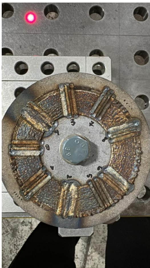
Figura 10. Proba inelară după aplicarea tratamentului cu fascicul laser pe sectoare distincte. Sectoarele numerotate corespund încercărilor planului factorial.
