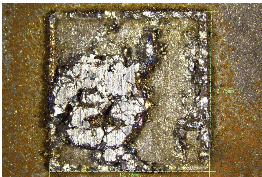
Figura 4. Proba M0 după rectificare – exfoliere extinsă și rețea poligonală de fisuri
