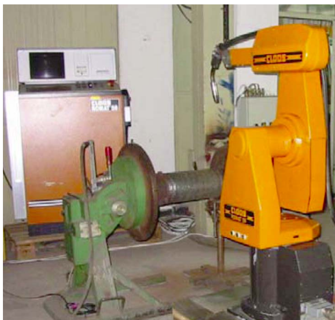
Celula flexibilă robotizată pentru încărcare prin sudare
