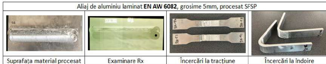
e) Exp.9A - Aliaj de aluminiu EN AW 6082 (grosime 5mm), procesat SFSP
