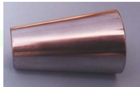
Ajutaj molibden ( \phi_{med} 36 mm, s_{perete} = 2 mm)
