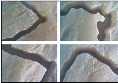
Tăieturi cu jet de apă - material plastic acrilic armat cu fibră de sticlă
