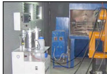
Instalație de pulverizare termică HVOF (UP Timișoara)
